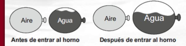
Al principio, ambos globos tienen volúmenes y temperaturas iguales, pero después de que los globos permanecieron durante varios segundos dentro del horno, el volumen y la temperatura del globo con agua aumentaron, sin que llegara a hervir, las del otro globo no cambiaron.
